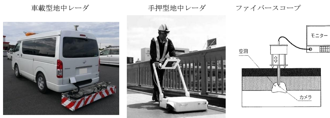
写真 5-10 路面下空洞探査の現場状況及び孔壁撮影イメージ
