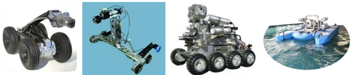
写真 5-3 大口径管きよ用のテレビカメラ (例)
