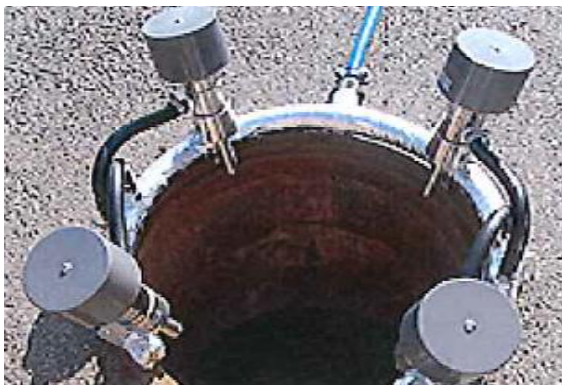
写真 4-1 無翼扇型送風機の設置状況とリング型送風機のイメージ図
