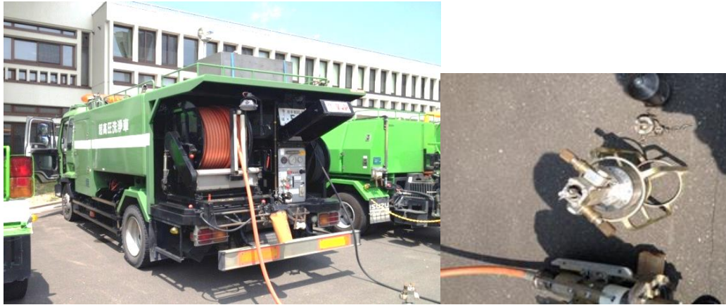
写真 3-11 超高压洗浄車とターボノズル
