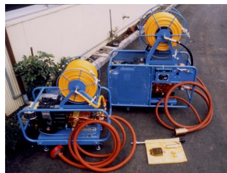
写真 4-1 小型高圧洗浄機の例
