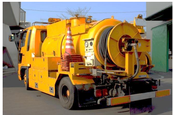
写真 3-2 高圧洗浄車両（例）
