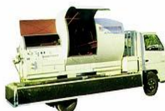
写真 4-3 ロッド清掃機器の例
