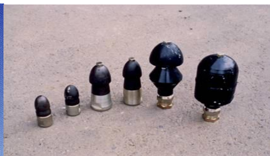
写真 3-4 洗浄ノズル（例）
