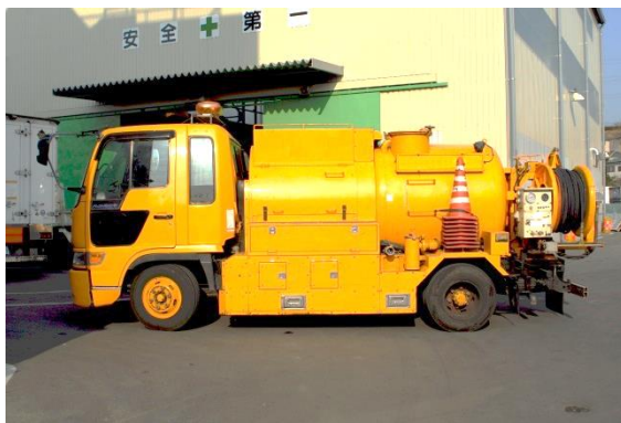
写真 3-2 高圧洗浄車両（例）
