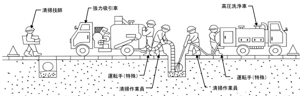
図 4-4 雨水ます清掃工の作業標準図
