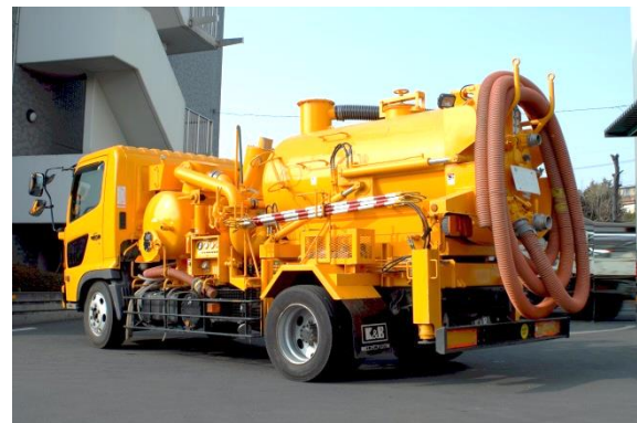
写真 3-8 強力吸引車(例)
