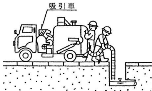
図 3-10 吸引車による方法
