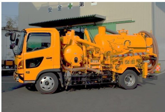
写真 3-8 強力吸引車(例)
