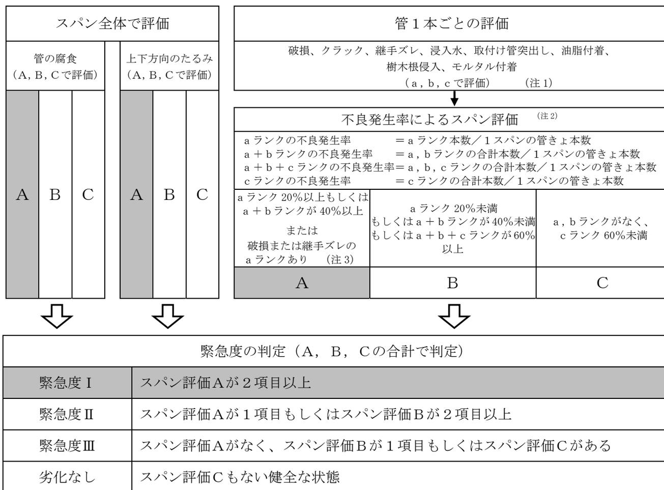
(注1) 「本試験」では、「取付け管の突出し」「油脂の付着」「樹木根侵入」「モルタル付着」は、清掃等で除去できる項目として、管 1 本ごとの評価のランク付け対象外とする。
