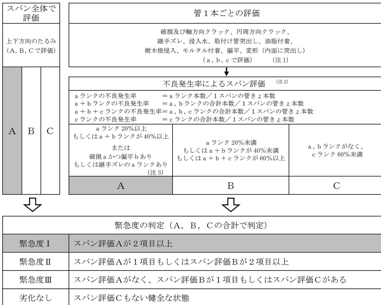
(注1) 「本試験」では、「取付け管の突出し」「油脂の付着」「樹木根侵入」「モルタル付着」は、清掃等で除去できる項目として、管 1 本ごとの評価のランク付け対象外とする。
