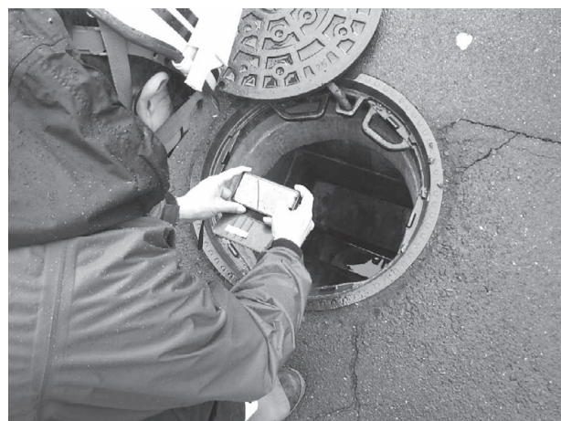
写真1 スマートフォン+GPSを活用したシステム（現場調査）
