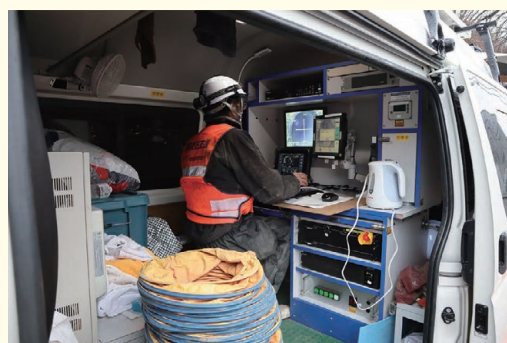
管内部の破損状況を確認
