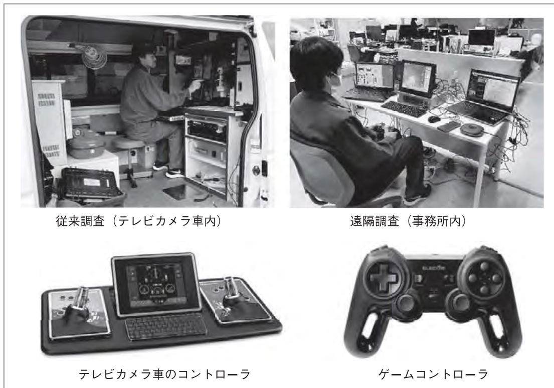
写真3 テレビカメラの操作環境とコントローラ
