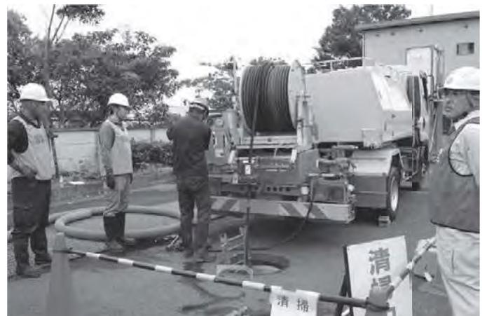
管路協では、下水道管路管理専門技士の清掃部門で高圧洗浄車を使用した実技試験を行っている
