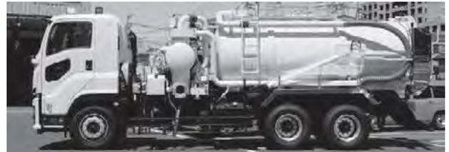
水封式真空ポンプ搭載新型クリーンキューム
