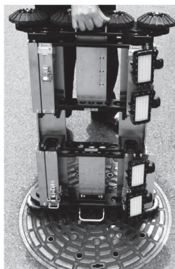
写真3 分解せずマンホールから挿入可能
