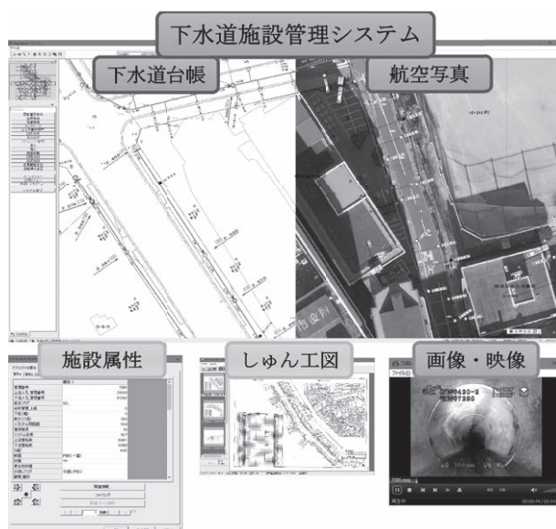
図3 下水道施設管理システム
