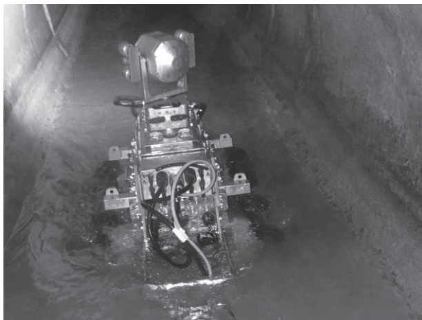
図3 大口径TVカメラによる調査
