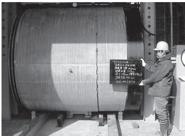
写真1 呼び径2,000による曲げ試験状況
