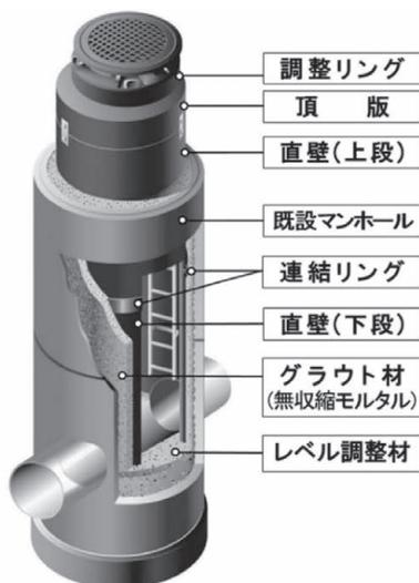
図1 RMI工法の標準施工手順
