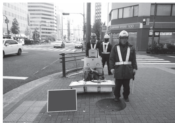
名古屋市のハンディタイプ空洞調査機 調査幅0.5m（上）、1.0m（下）
