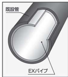
図-1 EX工法で更生した管きよの構造
