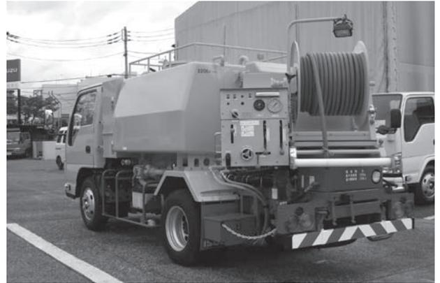
2t車クラスに2,400Lタンクと強力なポンプを積んだ最新鋭の洗浄車
