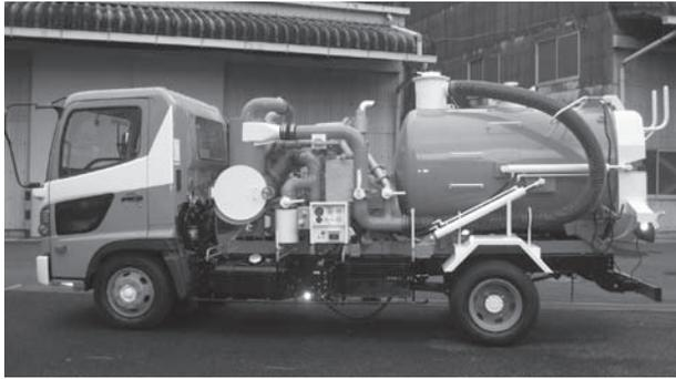
乾式ブロワを搭載した新型強力吸引車NS-04CVP
