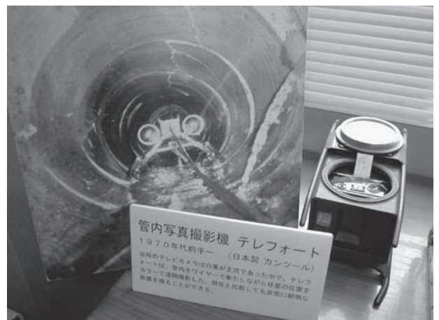
当時としては珍しい自動巻のカメラで静止画像を撮影していた（株）カンツールのテレフォート
