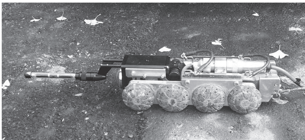
管内面形状計測ロボット
