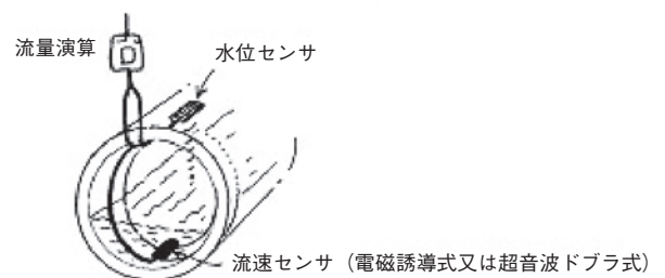
図-3 開渠・管渠式
