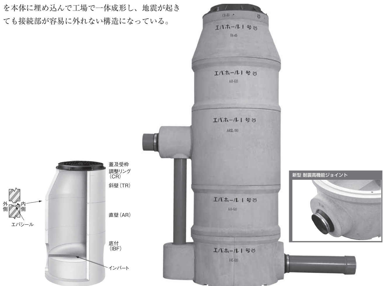
ゴム継手一体ソケット、インバート付の「新型エバホール」
