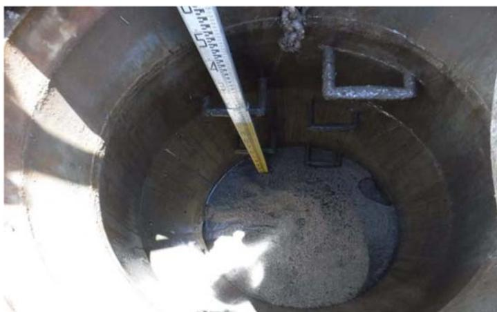
写真-4.2 管口の目視確認が不可能な場合の堆砂深の測定
